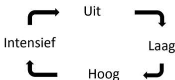
3. De derde snelheid is getimed en de afzuigkap schakelt na zeven minuten automatisch terug over naar de tweede snelheid.
