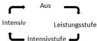
3. Die Stufe 3 ist zeitgesteuert. Somit wird die Dunstabzugshaube automatisch nach 7 Minuten auf Stufe 2 zurückgeschaltet.
