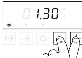
Nach ca. 3 Sek. startet die Schaltuhr, die Leuchte leuchtet ständig. In der Anzeige sehen Sie die Restzeit. Neben der Anzeige blinken die beiden Leuchten im Wechsel.
