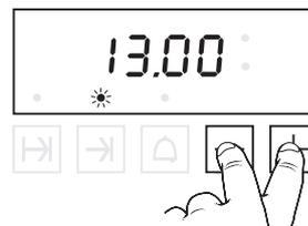
Nach ca. 3 Sek. startet die Schaltuhr, die Leuchte leuchtet ständig. In der Anzeige sehen Sie die Restzeit bis zum Garende. Neben der Anzeige blinken die beiden Leuchten im Wechsel.
