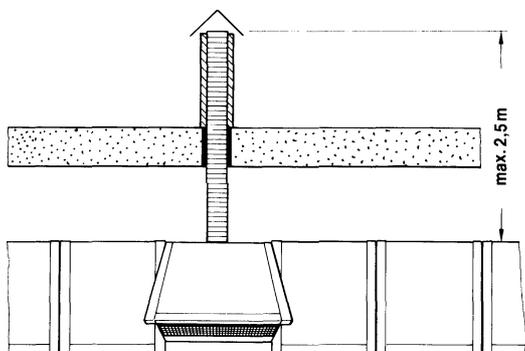
Die Steigungshöhe des Abluftrohrs darf 2,5 m nicht überschreiten. Das Rohr muß wärmeisoliert sein, oder es muß ein Wasserknie installiert werden.
