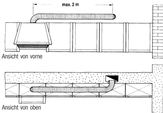
Die Abluft darf nur dann in einen bestehenden Abluftschacht eingeleitet werden, wenn dieser feuchtigkeitsisoliert und nicht feuerungstechnisch belegt ist. Lassen Sie sich die Benutzung des Schachts von dem zuständigen Schornsteinfeger genehmigen.
