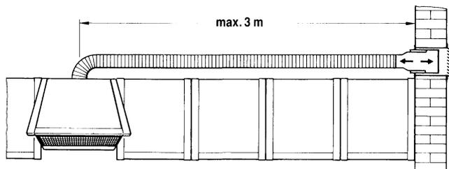
In der Außenwand wird ein Teleskop-Mauerkasten eingebaut, der sich auf unterschiedliche Mauerstärken einstellen läßt. Das Abluftrohr sollte eine leichte Neigung nach außen haben, damit das Kondenswasser ablaufen kann.
