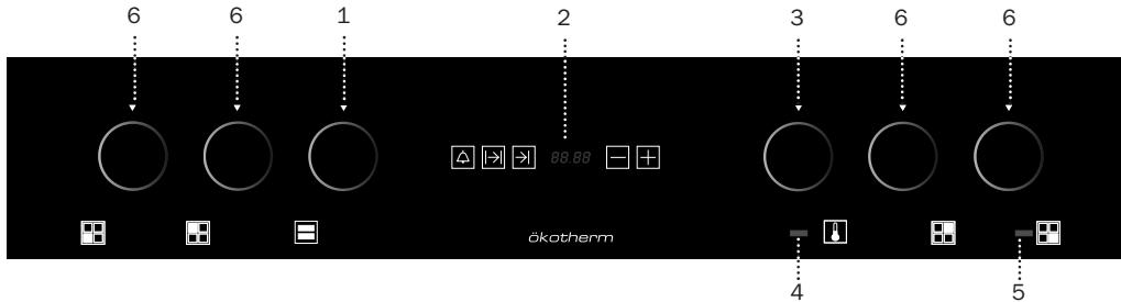
**1** Selector de funciones.**2** Reloj electrónico.**3** Selector de temperaturas.**4** Selector de funciones.**5** Piloto encimera.**6** Regulador de energía.**Funciones del Horno****0 Desconexión del horno****💡 Iluminación****▬ Convencional**
