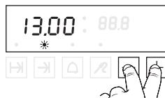
Una vez transcurridos aprox. 3 segs. se inicia el reloj, la lámpara se ilumina de modo permanente. En el indicador se muestra el tiempo que queda hasta la finalización de la cocción. Junto al indicador parpadean alternativamente las dos lámparas.
