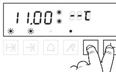
Após cerca de 3 seg. o temporizador começa a contar o tempo e as luzes permanecem acesas continuamente. Durante o tempo de espera até o início do cozimento o display indica «Auto». A indicação à direita mostra a temperatura interna actual no interior do assado.
