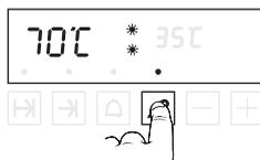
– Cambiare questa temperatura proposta di 70 °C con «+/-» portandola al livello desiderato. Dopo circa 3 secondi si avvia il timer, la spia sopra il selettore s'illumina continuamente.
