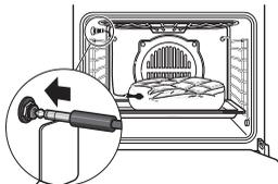
En la indicación de la derecha se indica la temperatura interior actual del asado: Dentro del rango entre 35 °C y 95 °C se ve la temperatura efectiva, con temperaturas por debajo de los 35 °C aparecen en el indicador «-- °C», con temperaturas por encima de los 95 °C parpadea en el indicador «95 °C».
