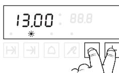
Após cerca de 3 seg. o temporizador começa a contar o tempo e a luz permanece acesa. O display indica o tempo remanescente até o término do cozimento. Ao lado do display, ambas as lâmpadas ficam a piscar alternadamente.
