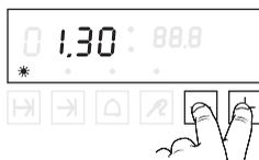
Após cerca de 3 seg. o temporizador começa a contar o tempo e a lâmpada permanece acesa continuamente. O display indica o tempo remanescente. Ao lado do display, ambas as lâmpadas ficam a piscar alternadamente.
