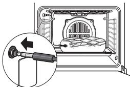
Nell'intervallo tra 35 °C e 95 °C è possibile vedere la temperatura effettiva; in presenza di temperature al di sotto dei 35 °C, compaiono sul display due trattini orizzontali («— °C»), in caso di temperature al di sopra dei 95 °C nel display lampeggia «95 °C».
