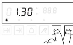
Una vez transcurridos aprox. 3 segs. se inicia el reloj, la lámpara se ilumina de modo permanente. En el indicador se muestra el tiempo que queda. Junto al indicador parpadean alternativamente las dos lámparas.
