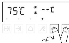
Quando a temperatura interna actual alcança o valor ajustado, o forno desliga-se e o display indica «End». Soa um sinal acústico. Ambas as lâmpadas ao lado do display param de piscar.
