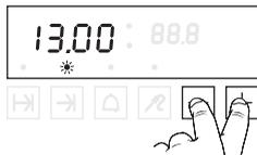
Una vez transcurridos aprox. 3 segs. se inicia el reloj, la lámpara se ilumina de modo permanente. Durante el tiempo de espera y hasta el inicio de la cocción aparece en el indicador parpadean alternativamente las dos lámparas.
