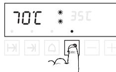
– Cambiar la temperatura propuesta de 70 °C con «+»/«-» hasta que el indicador señale la temperatura deseada.
