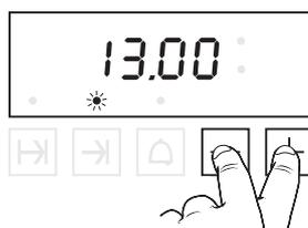
Dopo circa 3 secondi si avvia il timer, la spia s'illumina continuamente. Nel display si vede il tempo di cottura rimanente. Entrambe le spie poste accanto al display lampeggiano alternatamente.
