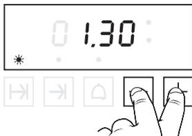
Após cerca de 3 seg. o temporizador começa a contar o tempo e a lâmpada permanece acesa continuamente. O display indica o tempo remanescente. Ao lado do display, ambas as lâmpadas ficam a piscar alternadamente.
