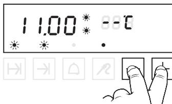
Dopo circa 3 secondi si avvia il timer, la spia s'illumina continuamente. Durante il tempo di attesa fino all'inizio della cottura, nel display compare la dicitura «Auto». Nel display destro viene visualizzata la temperatura effettiva della parte interna dell'arrosto.
